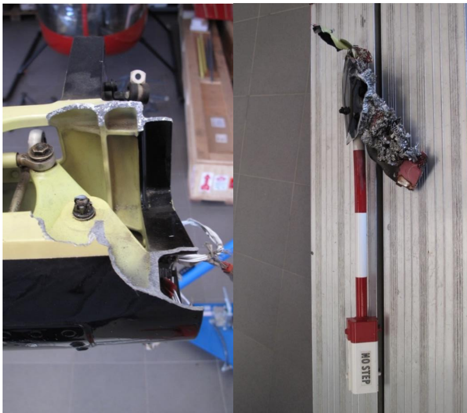
Φωτ. 2 – 3 Βάση στήριξης του κιβωτίου οδοντωτών τροχών ουραίου στροφείου - Ουραίο πέδιλο
