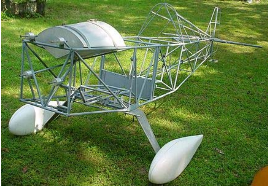
Φωτ. 4: Το α/φος SONERAI II όπου απεικονίζεται η μεταλλική κατασκευή της ατράκτου.
