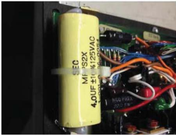
Φωτ. 2: Ο πυκνωτής C306 πριν και μετά την υπερθέρμανση.
