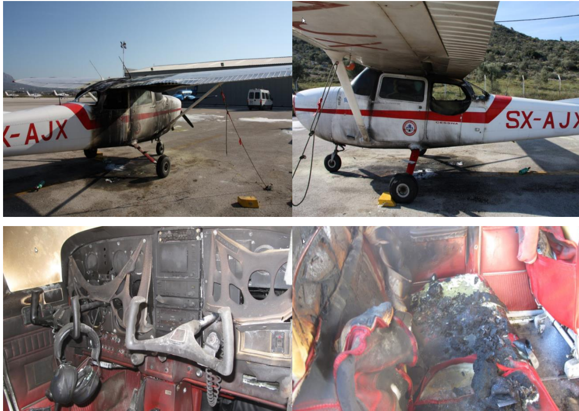
Εικόνα 2 Ζημιές α/φους στο εξωτερικό μέρος του και στο εσωτερικό της καμπίνας του.
