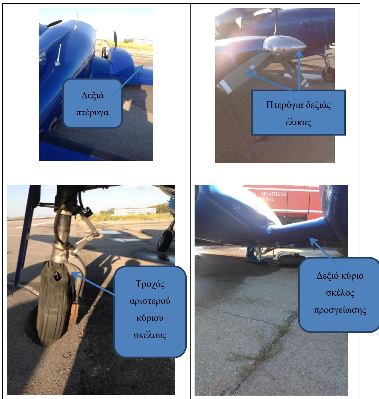
Εικ. 2 Εμφανείς ζημιές στο ακινητοποιημένο α/φος στον συνδετήριο.
