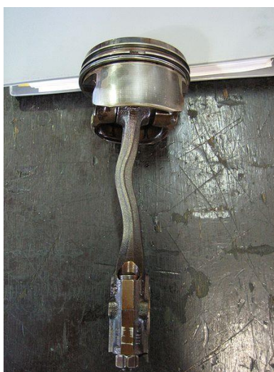
Εικ. 2 Παράδειγμα “υδραυλικώσης” σε έμβολο κινητήρα
