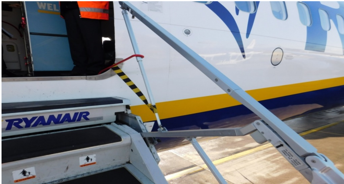
Φωτ. 4: Άνω τμήμα της πτυσσόμενης σκάλας.
